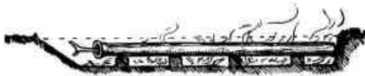
Horno de vapor en una zanja
